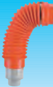
16 Flexibler Anschlußschlauch, L 50 cm, Ø 10 cm, mit herausnehmbarem Reduzierstück, 100/70 mm passend zu 15
