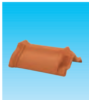
20 Lüfterfirstziegel LQ ca. 120 cm 2 /lfm., ca. 3 Stück/lfm.
