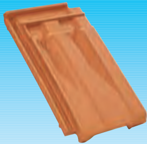
05 Flach-Entlüfter, LQ ca. 22 cm 2 / Stück, DIN 4108/3
