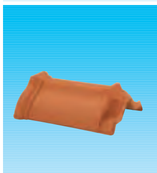
10 Lüfterfirstziegel LQ ca. 120 cm²/lfm., DL ca. 3 Stück/lfm., DB ca. 22,0 cm
