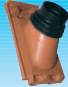
07 Thermenabgas-Durchgangspfanne, PVC, Ø 12,5 cm, ideal von ca. 25-40°
