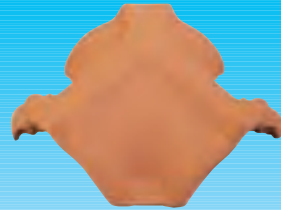
16 Walmkappe, passend zu Firstziegel Nr. 1, 3-achsig. Verlegung bei ca 12° - 45° Dachneigung, evtl. Anpassung nötig.
