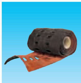
19 Blei-Trockengratband, gerippt, LQ ca. 170 cm²/lfm., B 28 cm, in 5 m-Rollen, passend zu Firstziegel Nr. 1, 2, 3 (B 19 cm bei Universal- Pulldachfirst)
