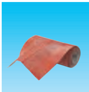
18 Alu-Trockenfirstband, gerippt, micro-perforiert, B 28 cm, in 5 m-Rollen, LQ ca. 157 cm²/lfm.
