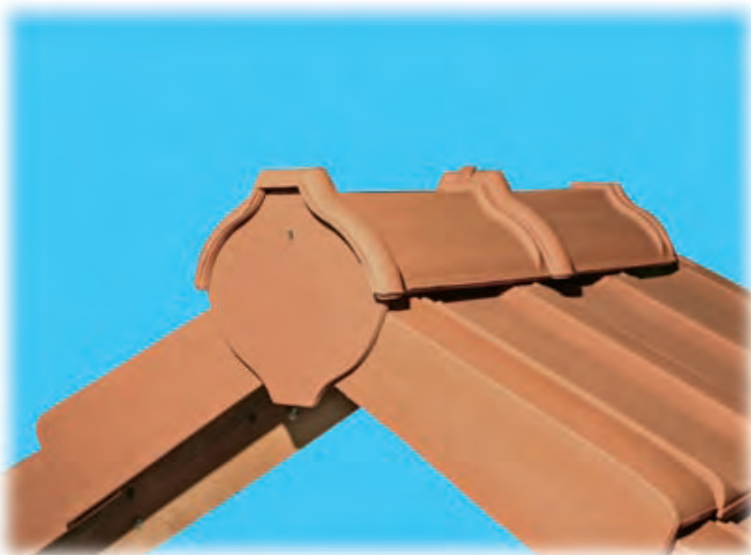
Abb. 5.2. Firstausbildung Firstziegel Nr. 1 mit keramischer Firstziegel-Anfänger- und Enderscheibe Nr. 1, lang, außenliegend (bündig mit Firstziegel), lose mitgeliefert. Diese ist stirnseitig an der Firstbohle zu befestigen.
