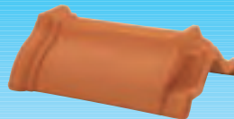
12 Lüfterfirstziegel LQ ca. 120 cm 2 /lfm., nach DIN EN 4108/3, DL ca. 3 Stück/lfm., DB ca. 22,0 cm.
