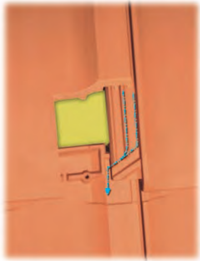
Wasserführung über Wasserweiche.
