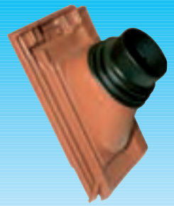
07 Thermenabgas-Durchgangspfanne, PVC, Ø 12,5 cm, ideal von 18 - 40°.
